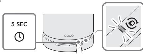
3. Premere nuovamente il tasto del timer per spegnere l'indicatore di sostituzione del filtro e completare l'inizializzazione.
